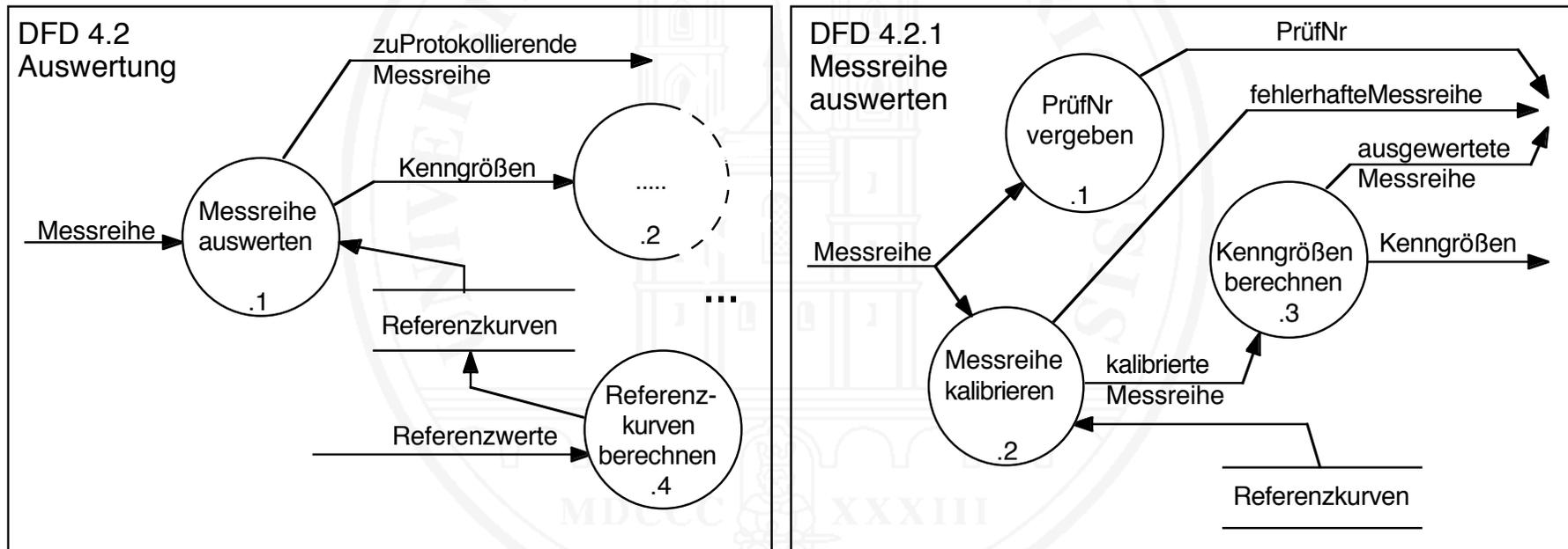
Auszug aus dem Datenlexikon: zuProtokollierendeMessreihe := PrüfNr + [ausgewerteteMessreihe | fehlerhafteMessreihe]
