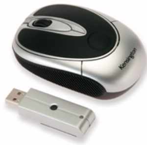
Abbildung 2.12: PilotMouse Mini Wireless. Mobile kabellose Maus mit aufsteckbarem Empfänger [35]
