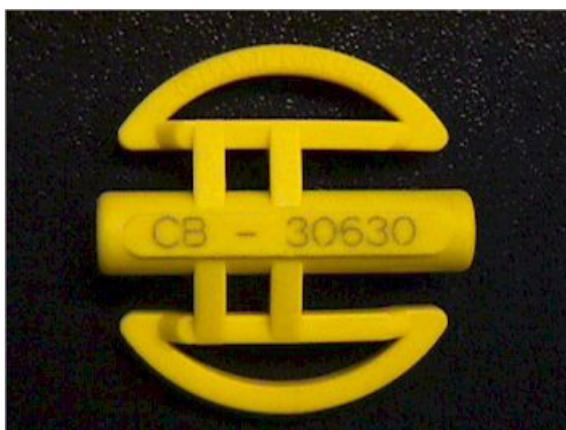
Abbildung 3.10: RFID Chip für Laufveranstaltungen
